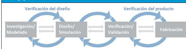
Fig. 5. Pasos de una metodología iterativa para el diseño de CPS [6].
