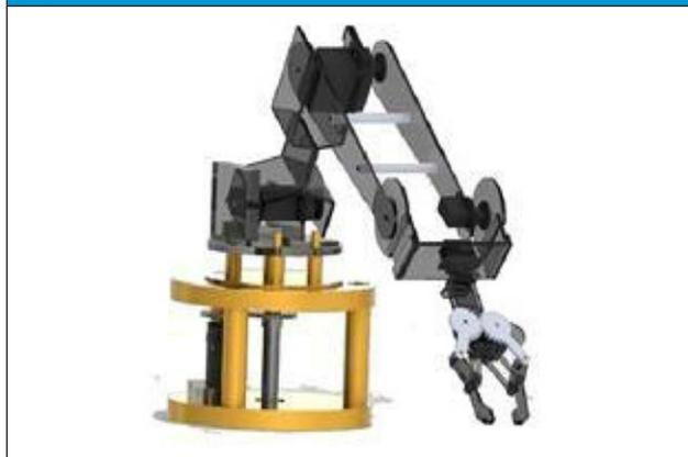
Tiene cinco movimientos separados: agarrar / liberar, levantar / bajar (2), rotar la muñeca y el pivote (de lado), que son controlados por las señales de arduino. Para efectos de su simulación se considerará al manipulador como un sistema mecánico formado por cuatro articulaciones, todas de rotación enlazadas en cadena abierta por medio de tres
